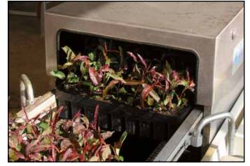
La velocidad de la cadena de transmisión puede ajustarse a la aplicación de más o menos agua.
