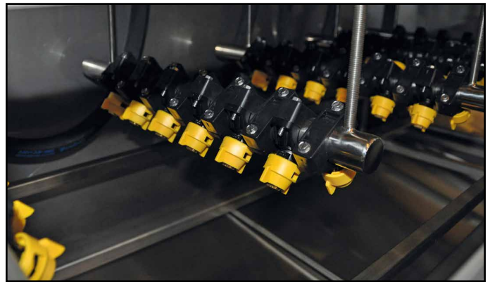
30 bocais de baixa pressão, em 5 tubos de pulverização, que garantem a lavagem completa das bandejas.
