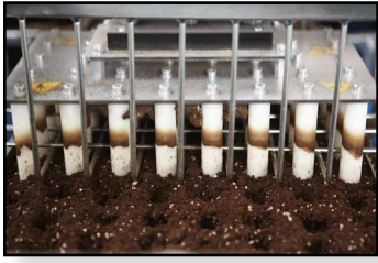
Vibração e enchimento de compactação ativo.
