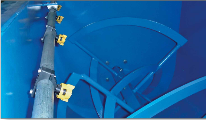
Línea de rociado de agua para aumentar el contenido de humedad del sustrato
