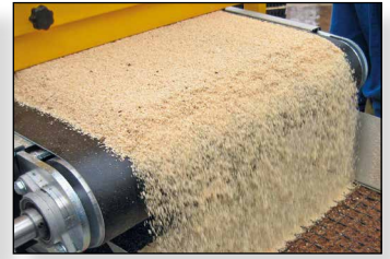
Aplicación de una capa uniforme para una homogénea germinación.
