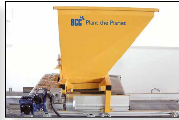
Tolva equipada con laterales ajustables.
