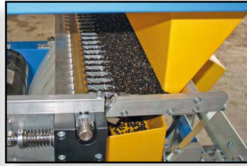
El posible derrame de semillas se recolecta en contenedores inferiores.
