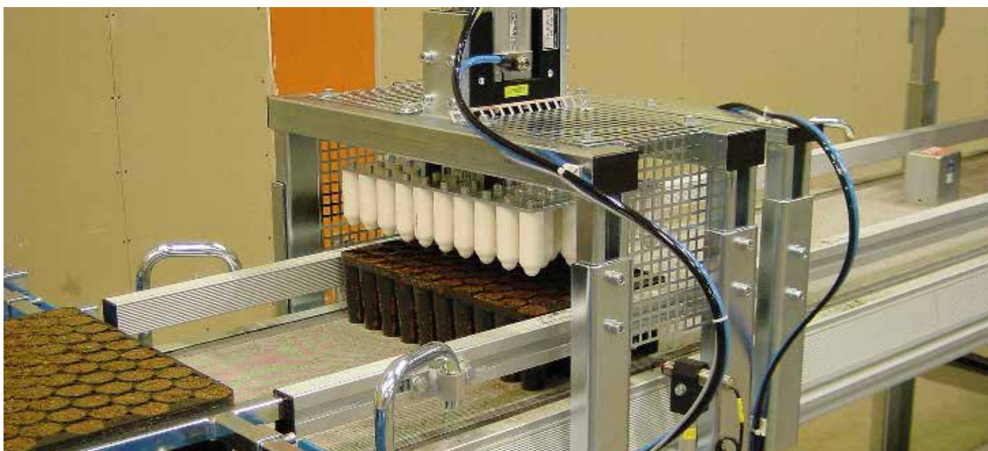
La placa es fácilmente intercambiable cuando se utilizan diferentes tipos de bandejas.
