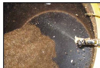
des-alado con proceso de aplicación de agua
