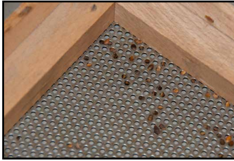
cribas con perforaciones redondas
