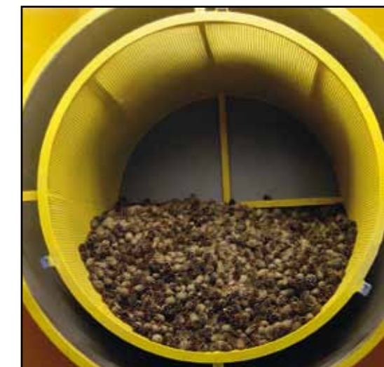
Вставной барабан заполняется шишками для извлечения семян
