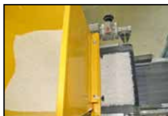
Воронка с материалом расположена над подающим транспортером
