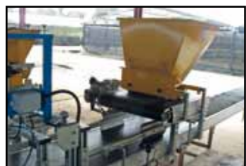
Воронка снабжена регулируемыми створками
