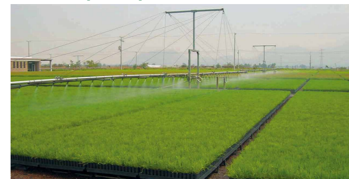
Поливочная рампа для площадки закаливания удовлетворяет требованиям по объемам подаваемой воды для лесопитомников, производящих культуры с ЗКС, и гарантирует гибкость и надежность эксплуатации
