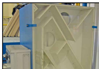
Стеклопанель позволяет наблюдать за процессом сепарации
