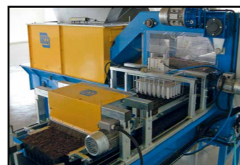
Быстрое и точное заполнение кассет субстратом
