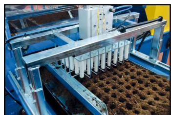
Заполнение кассет с функцией вибрации и активной трамбовки
