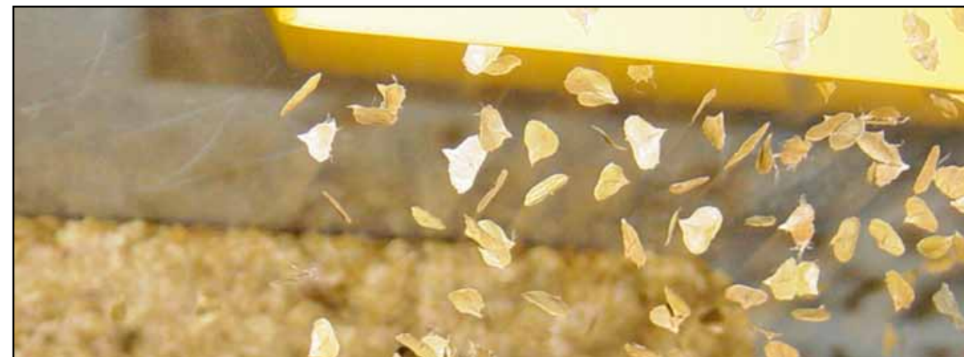
Система аспирации удаляет легкие частицы
