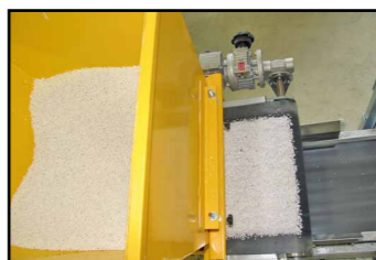
Zbiornik zamontowany nad taśmociągiem
