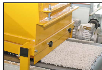
Zasuwa do regulacji grubości przykrycia
