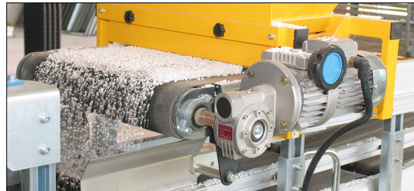
Przykrycie kaset po siewie cieką i jednolitą warstwą materiału
