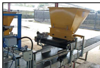
Zbiornik wyposażony w regulowane ścianki
