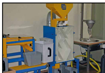
los controles de aire permiten modificar flujo de aire de acuerdo a especie
