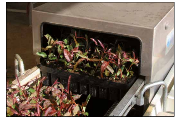
A velocidade da cadeia de transmissão pode ser ajustada para a aplicação de mais ou menos água.
